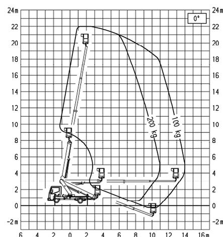
Die Arbeitsbereiche beziehen sich auf den ausgehobenen Steiger, d. h. Fahrzeugräder haben Bodenfreiheit. Die Aufstell-Neigung beträgt in diesem Beispiel max. 1°. Die Arbeitsbühne ist geschwenkt. Ab einer
