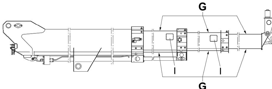
Das Teleskop zum Abschmieren (Fetten) so weit wie möglich ausfahren und die Gleitflächen („G“) dünn, z. B. mit Hilfe eines Heizkörperpinsels einfetten.
