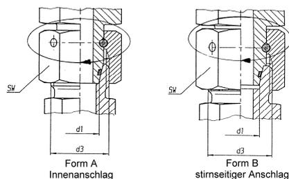
Beim Anziehen der Überwurfmutter den Verschraubungsstutzen mit einem Schraubenschlüssel gehalten.
