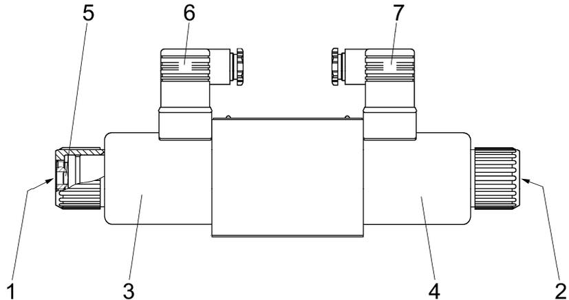
1. Handnotbetätigung links. Aufnahme für Betätigungsschraube der Magnetarretierung.
