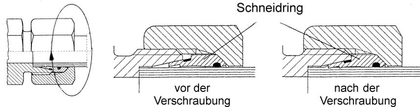
Der Schneidring wird auf Block montiert. Beim Anziehen der Überwurfmutter den Verschraubungsstutzen mit einem Schraubenschlüssel gehalten.
