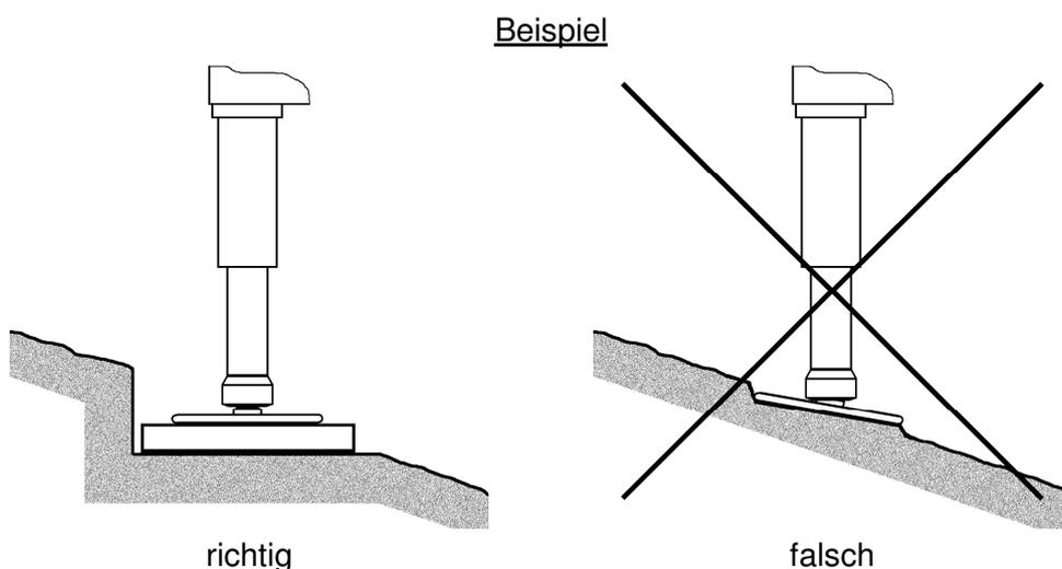
Die Stützen müssen sich während des Aufstellvorganges frei bewegen können. Es ist zu prüfen, ob der Untergrund den maximal auftretenden Belastungen unter den Stütztellern der Abstützung standhält. Die Stützkraft ist an den einzelnen Stützen angegeben.
