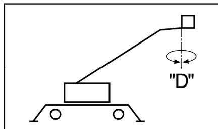
Die elektrische Ansteuerung von Steigerbewegungen kann im Gefahrenfall durch das Betätigen eines NOT-AUS-Schalters unterbrochen werden.
