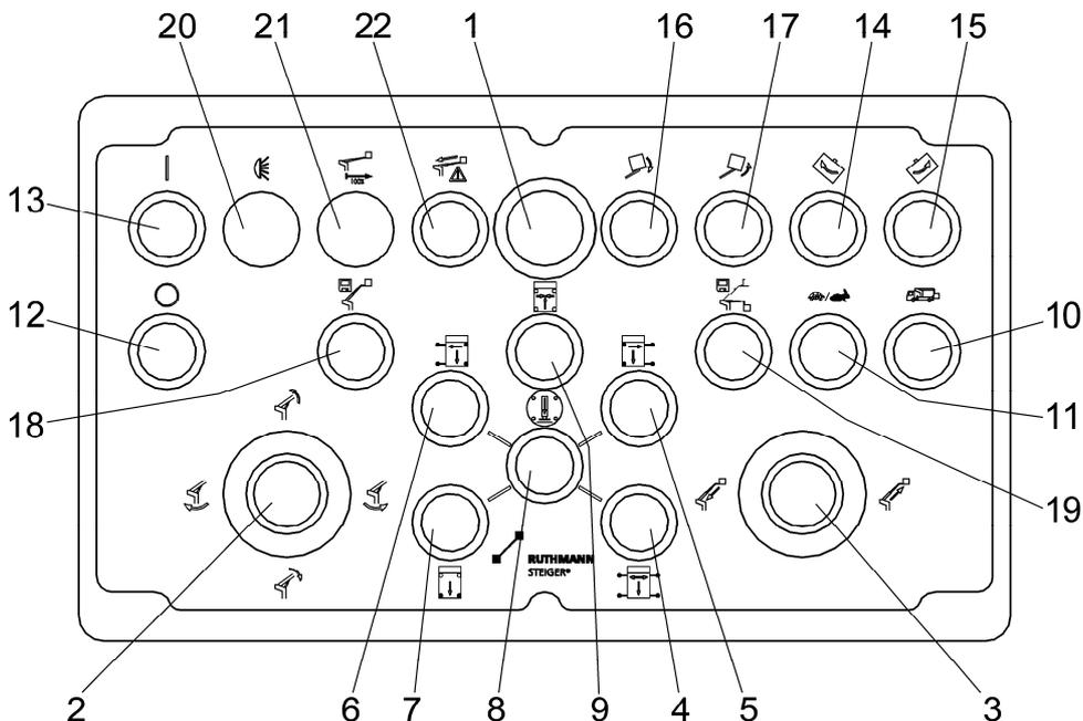
1. NOT-AUS-Schalter, rot ⇒ unterbricht sofort die elektr. Ansteuerung der Steigerbewegungen. Der Fahrzeugmotor wird abgestellt.
