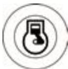
Erlaubt das Starten/Abschalten des Verbrennungsmotors. Wird die Taste bei laufendem Motor gedrückt, schaltet dieser ab.
