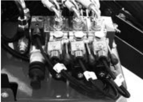
**Fig. 140** *Beispiel Bedienelemente auf Hydrauliksteuerung*
