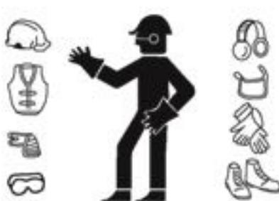
Tragen Sie möglichst keine weite Kleidung, Ringe, Uhren oder anderes, was sich in den sich bewegenden Teilen verfangen könnte. Tragen Sie bei der Arbeit mit der Maschine oder deren Wartung Schutzhelm, Schutzbrille, Sicherheitsschuhe, Handschuhe und Lärmschutzkopfhörer, nachdem Sie diese auf ihre Unversehrtheit kontrolliert haben, sowie jede weitere PSA, die der Sicherheitsbeauftragte entsprechend der von ihm vorgenommenen Gefahrenanalyse für erforderlich hält.
