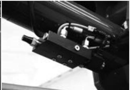
**Fig. 11** Zylinder-Sperrventil Ausleger
