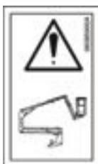
By-Pass Notfall Hubteil. Vorrichtung, die es erlaubt, absichtlich die Sicherheiten des Hubteils im Fall von Notfall-Vorgängen auszuschließen.
