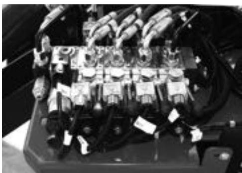
**Fig. 75** Bedienelemente auf linker Hydrauliksteuerung
