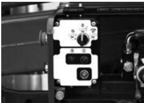
**Fig. 54** Wahlschalter Ausführung mit Verbrennungsmotor
