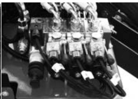
**Fig. 76** Bedienelemente auf rechter Hydrauliksteuerung
