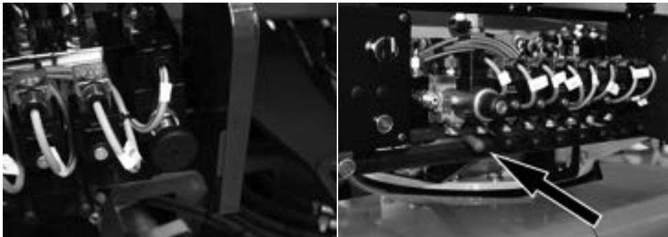
**Fig. 74** Knopf zur Aktivierung Proportionalventil Hubteil
