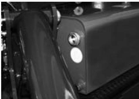
**Fig. 163** Füllstandanzeiger Hydrauliköl
