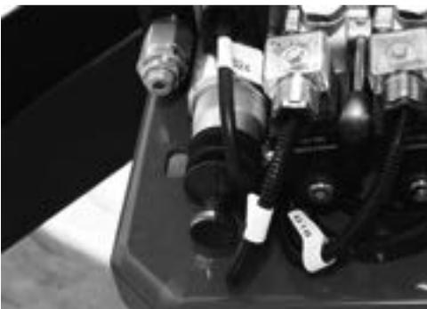
Fig. 139 Stellknopf Proportionalventil Fahrgestellteil
