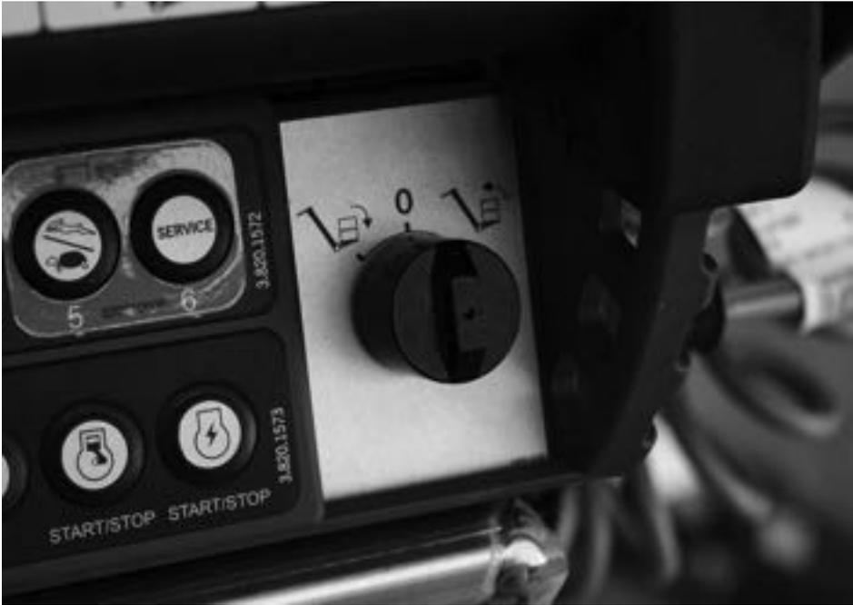
**Fig. 104** Schlüssel Korbnivellierung
