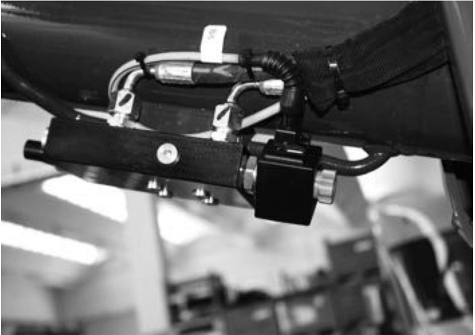
**Fig. 66** *Magnetventile zur Notabsenkung durch Schwerkraft*
