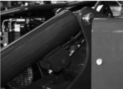
**Fig. 10** Sperrventil Stützfüße
