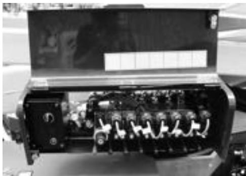
**Fig. 113** Bedienelemente auf Hydrauliksteuerung Hubteil
