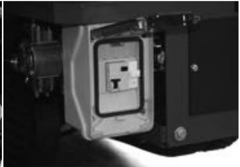
Fig. 144 Automatischer Leistungsschutzschalter
