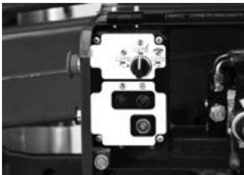
**Fig. 154** Wahlschalter Steuerung am Boden
