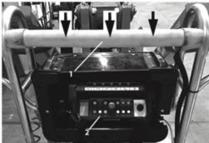
**Fig. 59** 1-Sensor SkyGuard™ 2- SkyGuard™ Bypass (Taste Nummer 8)
