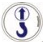
Hebepunkt. Zeigt die zu verwendenden Punkte für den korrekten Hub der Maschine an.
