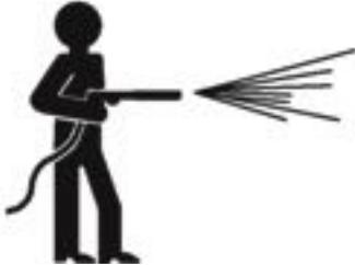
Richten Sie den Strahl eines Hochdruckreinigers während des Waschens der Maschine nicht auf elektrische Bauteile. Verwenden Sie keine chemischen Reiniger oder Benzin, denn dadurch können die Kunststoffteile und der Lack schwer beschädigt werden.
