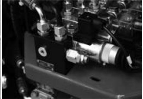
**Fig. 9** Überdruckventil Fahrgestell
