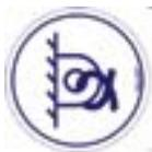
Die Anschlusspunkte der Befestigungssysteme sind mit dem entsprechenden Aufkleber gekennzeichnet .
