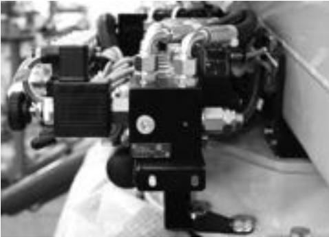
**Fig. 8** Überdruckventil Hubteil
