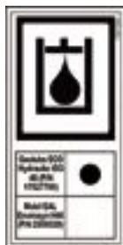
Im Falle, dass die Maschine mit biologisch abbaubarem Hydrauliköl erstellt wurde, ist in der Nähe der Einfüllkappe des Hydrauliktanks ein Aufkleber anwesend, der den Typ von verwendetem Öl und die verträglichen Öle im Falle von Nachfüllen anzeigt.
