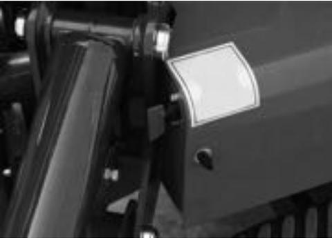
**Fig. 6** Batterietrennschalter Verbrennungsmotor
