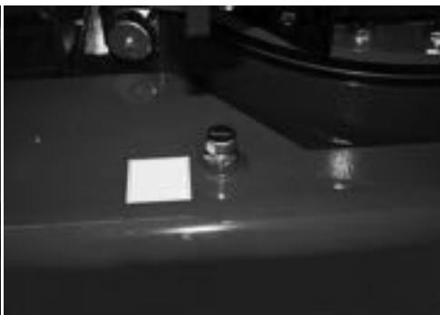
**Fig. 164** Einfüllkappe Tank Hydrauliköl
