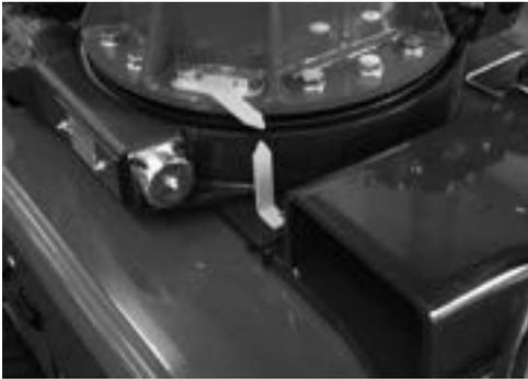
Die komplette Schließung und Ausrichtung der Maschine werden von den bezüglichen Pfeilen auf der Maschine selbst und durch die Visualisierung des Symbols in Position 6 auf der Fernbedienung angezeigt "Fig. 38 Hubteil geschlossen und ausgerichtet(p. 56)".
