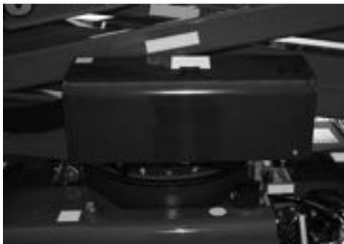
**Fig. 56** Verkleidung Hydrauliksteuerungen am Boden
