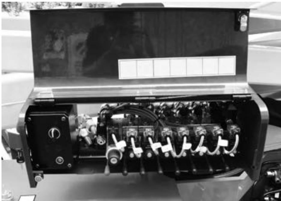
Fig. 72 Bedienelemente auf Hydrauliksteuerung Hubteil
