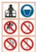
Verwenden Sie die Sicherheitsgurte, gebrauchen Sie die persönlichen Schutzausrüstungen (Helm), Verbot der Ausführung von Schweißungen auf der Maschine, Verbot des Gebrauchs von Leitern oder anderen Systemen zur Erhöhung des Arbeitsbereichs im Inneren des Bedienerkorbs, Verbot der Arbeit in der Nähe von elektrischer Spannung, Verbot des Gebrauchs der Arbeitsbühne zum Hub von Lasten.
