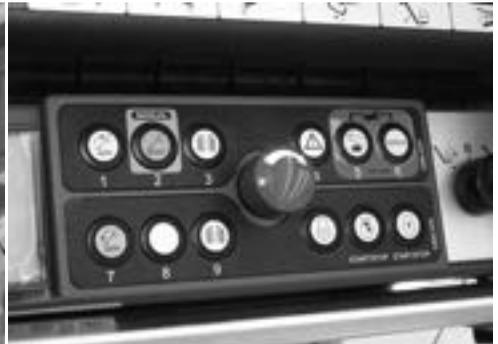
**Fig. 61** Not-Aus-Taste auf Fernbedienung
