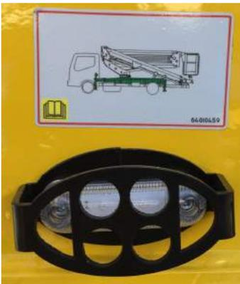
Die **ORANGEFARBENE LED LEUCHTET** wenn die Steuerung im unteren Teil der Plattform aktiviert ist und folgende Konditionen für die Steuerung der Abstützungen vorliegen:
