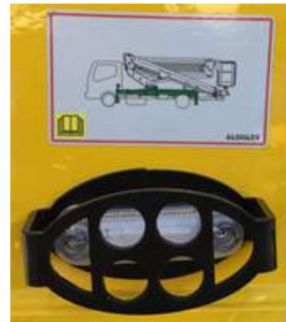
3. Aktivieren der Hebel für die Stützbeine nach hinten, werden die Abstützungen nach unten bewegt und der Chassis vom Boden abgehoben. Wenn alle Abstützungen sind auf dem Boden, ist die grüne Lampe (1) auf.
