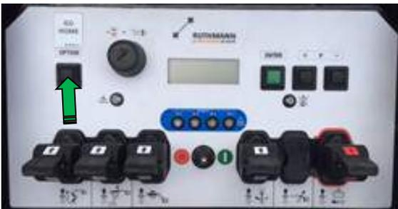
Betätigung dieses Schalters (OPTION) schließt die Plattform automatisch
