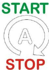
Bei den RUTHMANN ECOLINE Hubarbeitsbühnen ist es möglich, die **AUTOMATIK START & STOPP FUNKTION des Antriebmotors** für die Reduzierung des Kraftstoffverbrauchs und der Abgasemissionen zu aktivieren.
