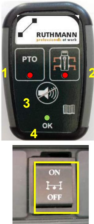
1. **Rote Kontrollleuchte PTO:** ihr Leuchten zeigt an, dass die Zapfwelle eingekuppelt ist.
