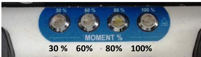
Diese LEDs zeigen die Ausfahrlänge des Teleskopauslegers an. **Wenn der Bediener die maximale Reichweite erreicht hat, brennen alle LED's**
