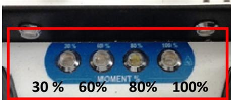
Diese LEDs zeigen die Ausfahrlänge des Teleskopauslegers an. **Wenn der Bediener die maximale Reichweite erreicht hat, brennen alle LED's**
