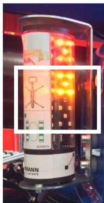
Die orangefarbene LED am Chassis leuchtet, wenn die Steuerung im unteren Teil der Plattform aktiviert ist und folgende Konditionen für die Steuerung der Anstützungen vorliegen:
