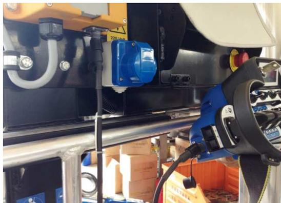
Sollte die Hubarbeitsbühne in der Nähe eines Flughafens oder eines anderen Ortes, wo die Benutzung von Funkfernbedienungen untersagt ist, verwendet werden, kann die Fernbedienung auch mittels eines Kabels an die Maschine angeschlossen werden.
