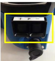
**5 - Drücken Sie die beiden schwarzen Tasten erneut für 3 Sekunden** auf der linken Seite der Funkfernbedienung, um zum **Standard Display** zurückzukehren
