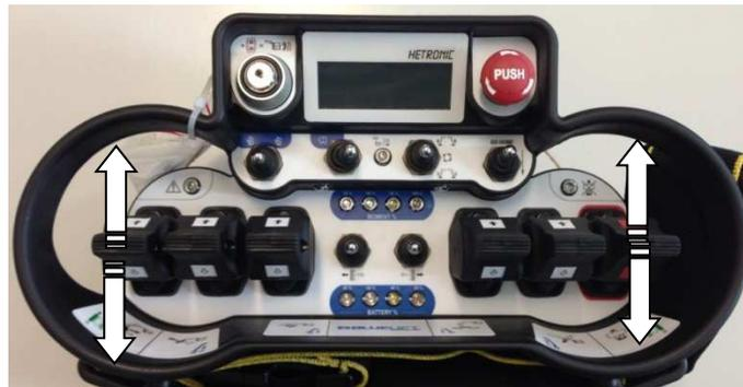
Bedienen Sie die beiden Hebel von der Fernbedienung gleichzeitig nach vorne und nach hinten, um eine Transportbewegung in eine oder eine andere Richtung durchzuführen. Durch individuelles Bedienen der Hebel kann das Gerät gelenkt werden. Durch diese Steuerung kann eine Gegendrehung auf die andere Spur verstärkt werden.
