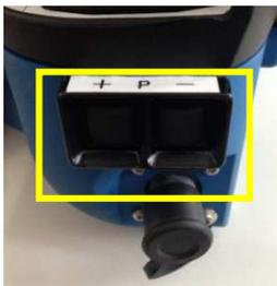
5 Drücken Sie die beiden schwarzen Tasten erneut für 3 Sekunden auf der linken Seite der Funkfernbedienung, um zum Standard Display zurückzukehren:
