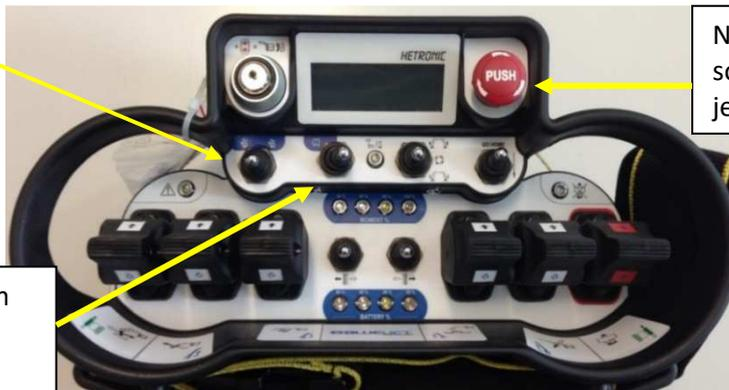
Not-Aus – Taster für die sofortige Unterbrechung jeder Funktion
