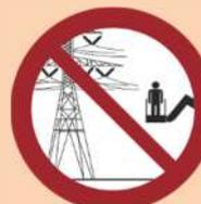
Das Arbeiten in der Nähe von freiliegenden Stromleitungen; halten Sie den Sicherheitsabstand ein wie von den geltenden Normen vorgesehen.
