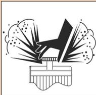
NICHT versuchen, die Hydraulikleitungen oder -anschlüsse bei laufendem Motor oder unter Druck stehendem Hydrauliksystem zu reparieren bzw. festzuziehen. Für den Druckablass in der Anlage die hydraulischen Steuerungen betätigen.
