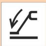
Verwendung der Funkfernsteuerung, wenn die Maschine nicht korrekt abgestützt wurde (nur für Maschinen mit Abstützungen).
