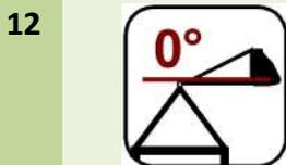
Das Anbaugerät vor dem Befördern von Lasten nivellieren.
