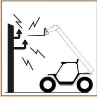
Nähern Sie die Last oder die Maschine nicht den Stromleitungen an. Die Maschine ist nicht elektrisch isoliert und mit keinem Kontakt- oder Annäherungsschutz in Bezug auf elektrischen Strom ausgestattet.
