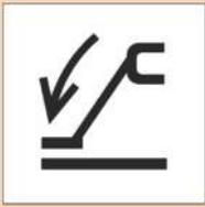
Der Gebrauch der Hubarbeitsbühne, wenn die Maschine nicht ordnungsgemäß stabilisiert ist (nur bei mit Abstützungen ausgestatteten Maschinen)
