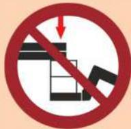
Die Benutzung der Arbeitsbühne als Stütze und/oder Zugstange, um andere Tragwerke oder Maschinen zu stützen.
