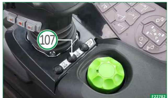
Zum Speisen der vorderen Hydraulikanschlüsse am Teleskoparm die Zusatzsteuerung AUX verwenden.
