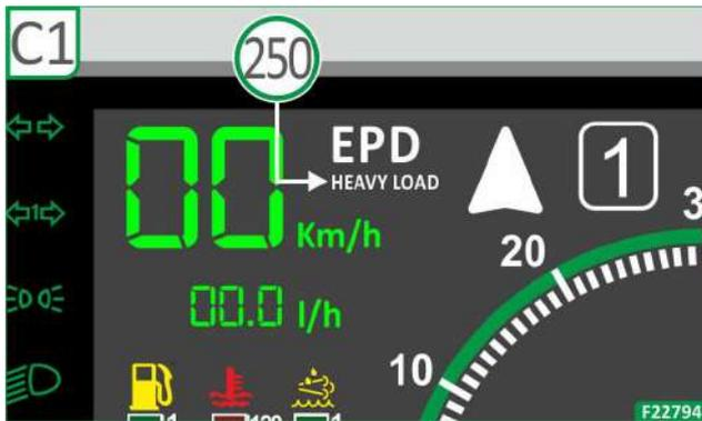
Diese Funktion (Feld 250 des ARMATURENBRETTS C) kontrolliert automatisch die **Motordrehzahl** während der Fahrt je nach Betriebsbedingungen.
