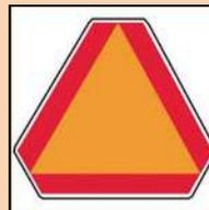
Bringen Sie ggf. das Schild „LANGSAMES FAHRZEUG“ am Heck der Maschine an.
