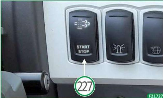
Die Aktivierung des Reinigungsvorgangs wird durch die automatische Erhöhung der Motordrehzahl auf eine voreingestellte Stufe angezeigt.
