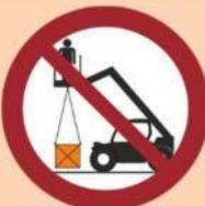
Schwebende Lasten zu transportieren, die mit Seilen, Ketten, Gurten oder anderen Systemen am Rahmen der Arbeitsbühne befestigt sind.
