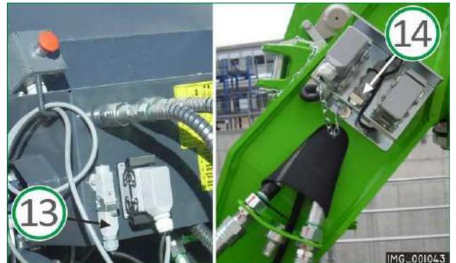
(Sofern installiert) den Aktivierungsstecker der kontinuierlichen Zufuhr (13) des Anbaugeräts an der entsprechenden Steckdose (sofern installiert) am Ende des Teleskoparms der Teleskopmaschine (14) verbinden.
