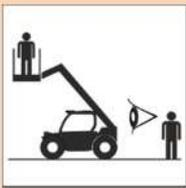
Der Gebrauch der Arbeitsbühne, wenn sich am Boden keine Person für die Überwachung befindet, die auf die Bedienung der Maschine, der Arbeitsbühne und der Maßnahmen im Notfall eingeschult ist, um bei Notfällen oder einer Panne an der Maschine gefahrlos eingreifen zu können.
