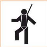
Auf der Arbeitsbühne zu arbeiten, ohne die Sicherheitsgurte umgelegt und an den Befestigungspunkten an der Arbeitsbühne befestigt zu haben
