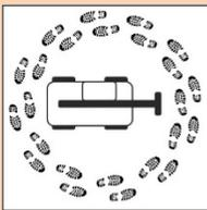
Kontrollieren Sie die Maschine und alle Anbaugeräte zu Beginn jedes Arbeitstages wie im ABSCHNITT 2 spezifiziert.
