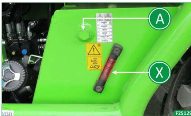
Mit einem 36 mm-Sechskantschlüssel den Einfüllverschluss (A) lösen und das vorgeschriebene Öl einfüllen (siehe MODUL 5). Den Einfüllverschluss (A) wieder anschrauben.
