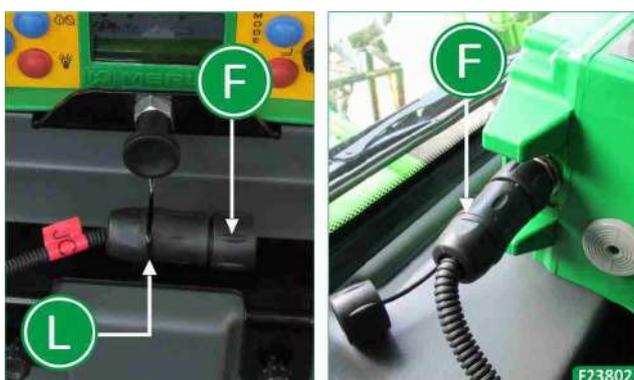
Beim Anschluss des Kabels sendet die Steuereinheit ein akustisches Signal aus, und, falls die Batterien aufgeladen werden müssen, wird bis zum Ende des Ladevorgangs die entsprechende Ansicht angezeigt.
