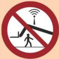
Aufenthalt und/oder Überqueren des Arbeitsbereichs der funkferngesteuerten Maschine.
