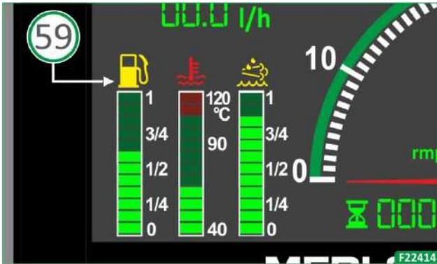
Zum Kontrollieren des Füllstands die Anzeige (59) verwenden.
