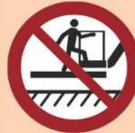
Die Arbeitsbühne zu betreten oder verlassen, wenn dies nicht am Boden ist bzw. ohne den vorgesehenen Zugang zur Arbeitsbühne zu verwenden.
