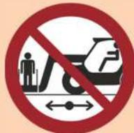
Das Umsetzen der Maschine, wenn sich Personen auf der Arbeitsbühne befinden.
