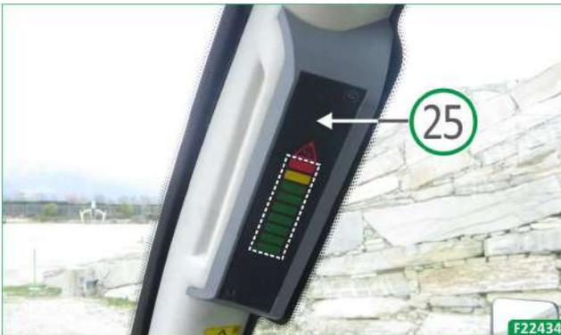
Die Lastkontrollanzeige (25) liefert schrittweise folgende Anzeigen:
