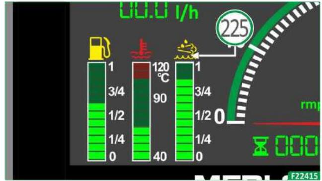
Zum Kontrollieren des Füllstands die Anzeige (225) verwenden.
