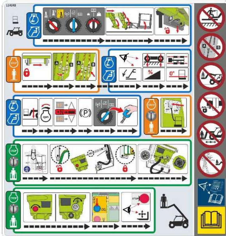
Aufkleber mit den Verhaltensregeln für die Benutzung der schwenkbaren Arbeitsbühne.
