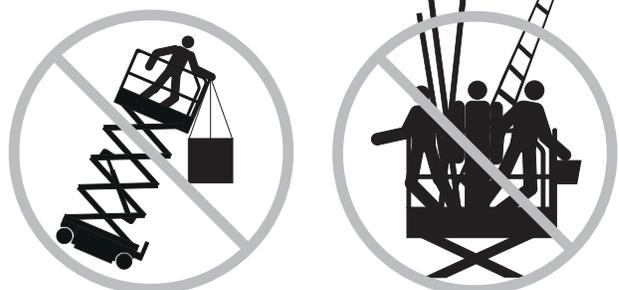
Verwenden Sie keine Leitern oder Gerüste auf der Plattform, und stützen Sie Leitern oder Gerüste nicht an der Maschine ab.
