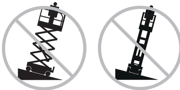
Überprüfen Sie, ob die Maschine waagrecht steht, und verlassen Sie sich nicht auf den Neigungsalarm. Der Neigungsalarm am Fahrgestell ertönt, wenn die Maschine auf abschüssigem Gelände steht.
