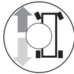
Verwenden Sie die farbkodierten Richtungspfeile an der Plattformsteuerung und auf der Plattform, um die Richtung festzustellen, in die die Maschine fahren wird.
