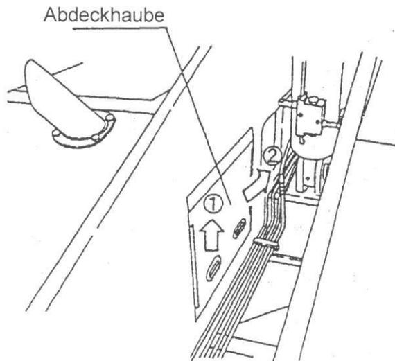
**Achtung:** Den Deckel durch anheben und abziehen entfernen.
