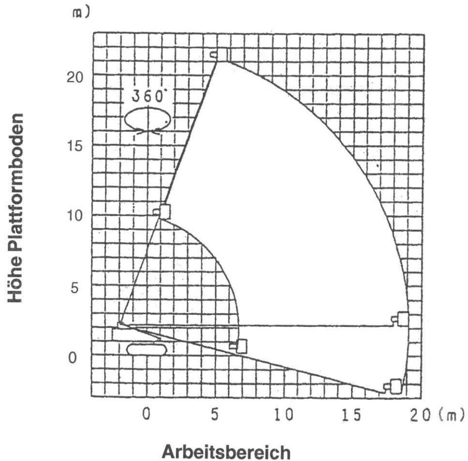
1. In dem obigen Arbeitsdiagramm ist die Mastdurchbiegung nicht berücksichtigt.
