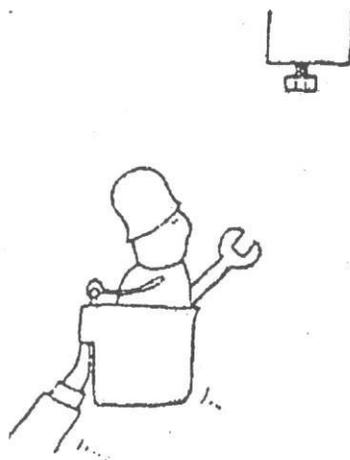
3. Wählen Sie die Funktion „teleskopieren“, um so nahe wie möglich mit dem Arbeitskorb an das Objekt heranzufahren.
