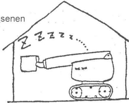
**Bemerke :** Wenn Sie gezwungen sind, eine Stahlkettenmaschine im Freien zu lagern, bedecken Sie diese mit einer Plane.
