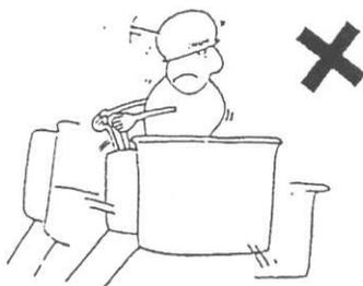
**Gefahr:** Wenn Sie die Maschine in die falsche Richtung bewegen, beenden Sie erst die Funktion und Fahren danach neu an.
