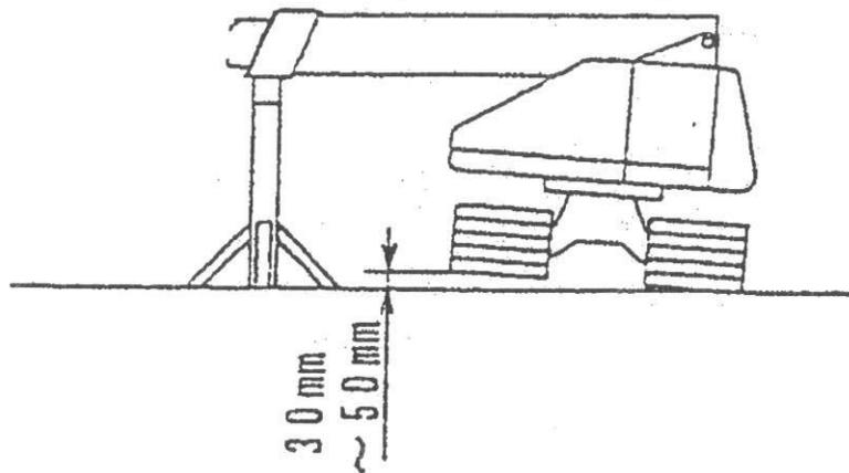
**Vorsicht :** Die Funktion Teleskopsenken unbedingt von der Bodenkontrolle aus betätigen.
