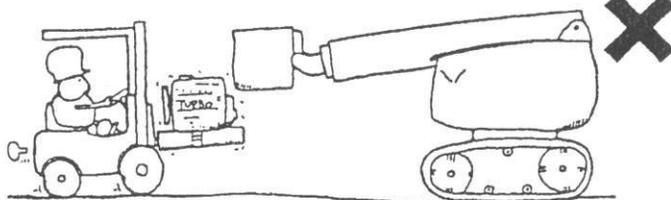
Bringen Sie nichts an der Maschine an, das die Windlast erhöht wie z.B. Ablagen oder Schilder an der Plattform.
