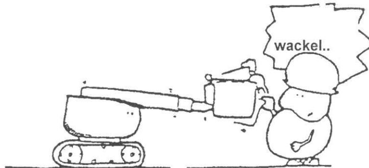
10. Das Teleskop bis auf maximale Höhe ausfahren und sicherstellen, dass das Teleskop nicht selbstständig einfährt.
