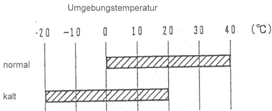
**Achtung :** Wenn die Umgebungstemperatur niedriger ist als die angegebene Betriebstemperatur des genutzten Hydrauliköls, lassen Sie die Maschine warmlaufen bis das Hydrauliköl seine Betriebstemperatur erreicht hat, und beginnen erst dann mit der Arbeit.
