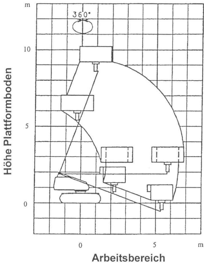
1. In dem obigen Arbeitsdiagramm ist die Mastdurchbiegung nicht berücksichtigt.
