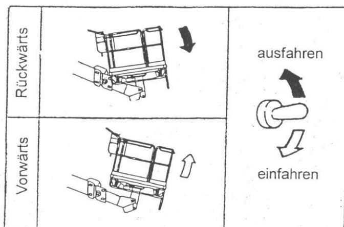
5. Wenn sich der Arbeitskorb endlich in der Horizontalen befindet schließen Sie die beiden Ventile zur Plattformnivellierung (1) und (2).
