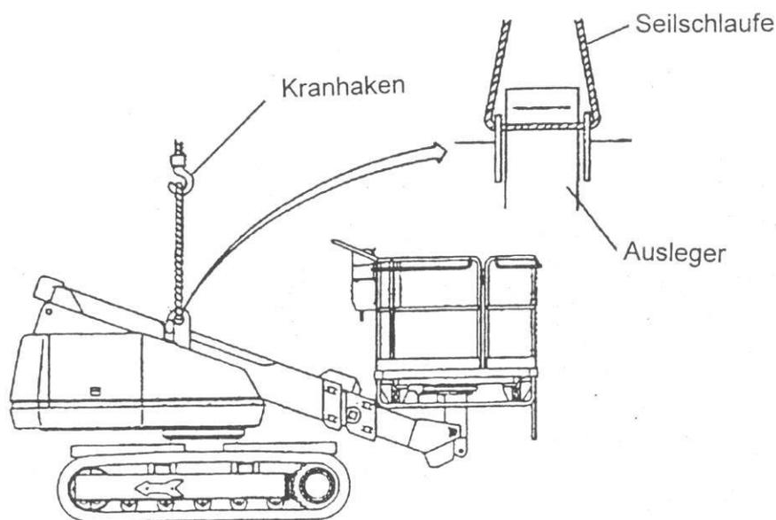
**Achtung :** Stellen Sie sicher, daß die Plattform vollständig entladen und der Ausleger vollständig eingefahren ist.
