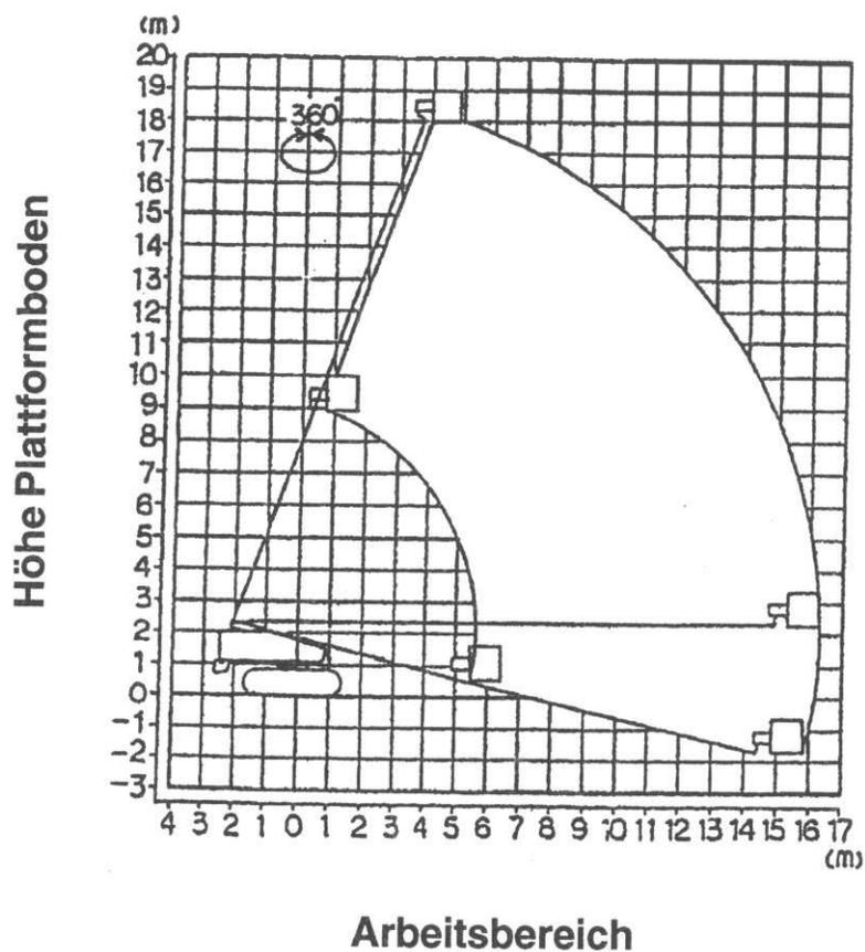
1. In dem obigen Arbeitsdiagramm ist die Mastdurchbiegung nicht berücksichtigt.
