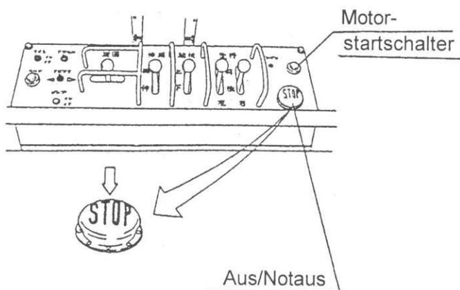
**Achtung :** Um die Arbeitsmaschine zu reaktivieren, ziehen Sie den Aus/NotausKnopf und drücken Sie den Startknopf am oberen Bedienpult oder drehen den Schlüsselschalter am unteren Bedienpult auf Start.
