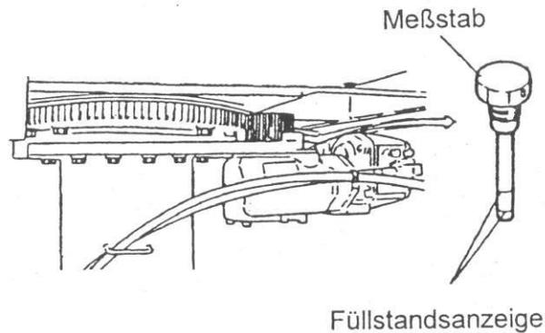
2. Bei einem Ölwechsel ist zuerst das alte Öl vollständig abzulassen bevor frisches Öl bis zu der gekennzeichneten Markierung aufgefüllt wird. (Ölfüllmenge = 0,6 Liter)
