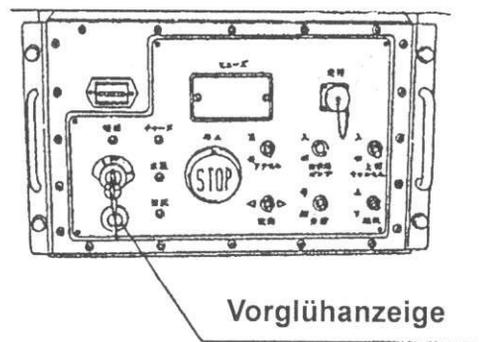
**Achtung :** Wenn Sie den Motor das erstmal starten oder er länger gestanden hat drehen Sie den Schlüsselschalter in Position „H“ und starten den Motor nachdem die Vorglühanzeige anspricht.
