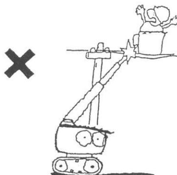
**Gefahr:** Diese Maschine ist nicht isoliert. Berühren Sie keine elektrischen Kabel, Oberleitungen etc..
