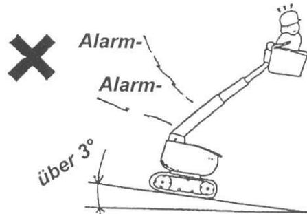
**Gefahr:** Wenn das Gerät schräger als 3° steht, ertönt ein Warnsignal. Führen Sie keine weiteren Hebebewegungen aus solange der Alarm anhält.
