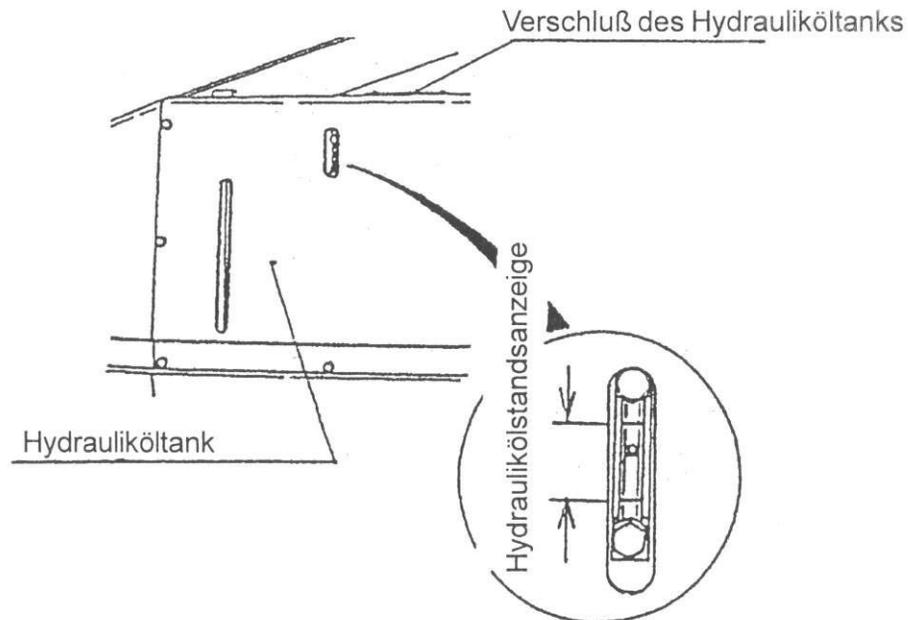
**Bemerke:** Prüfen Sie den Hydraulikölstand unter folgend aufgeführten Bedingungen.
