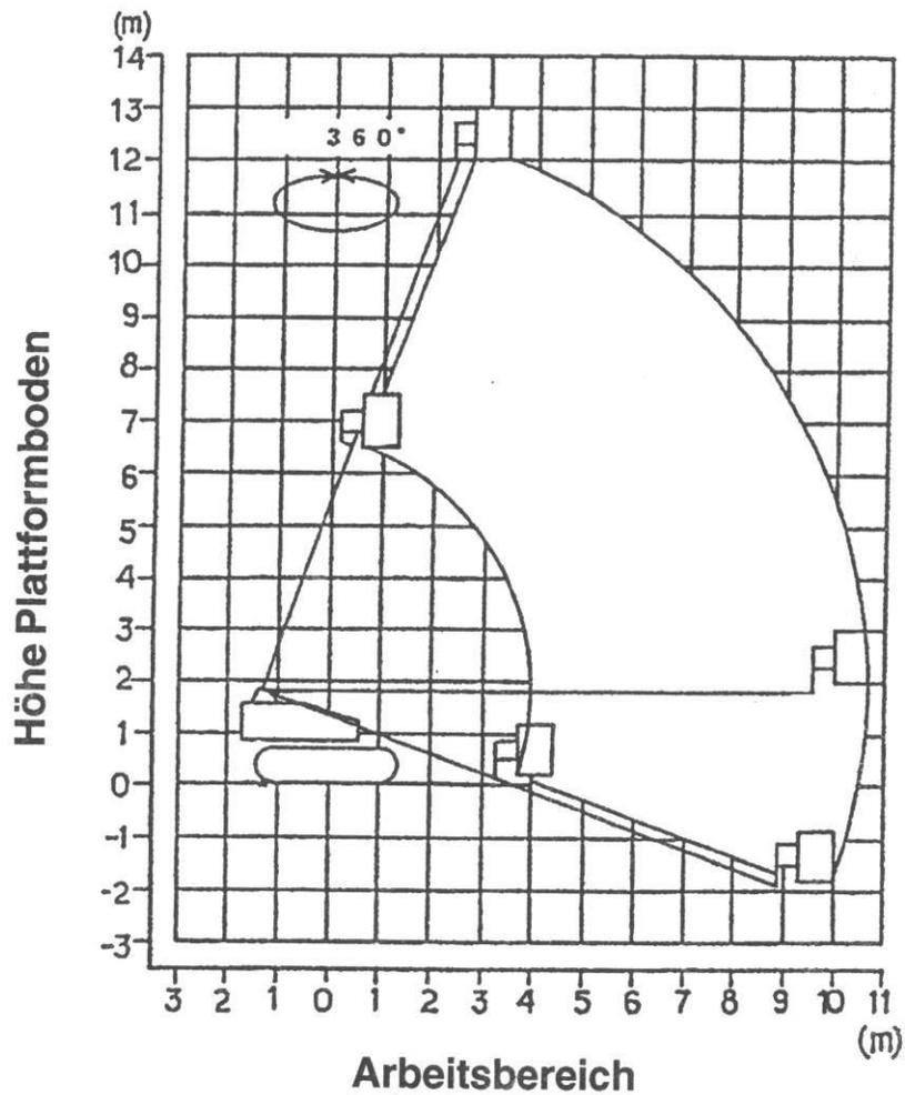
1. In dem obigen Arbeitsdiagramm ist die Mastdurchbiegung nicht berücksichtigt.
