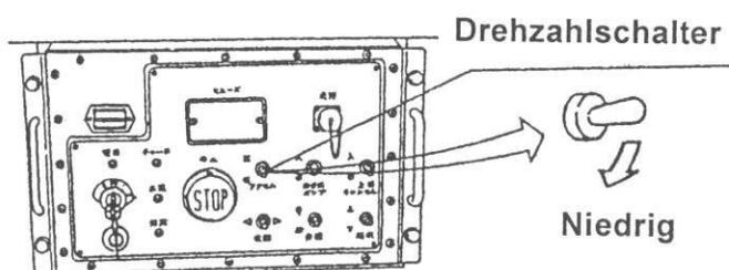
**Achtung:** Den Drehzahlwalschalter in die Position niedrig schalten, wenn der Motor gestartet wird. Wird dies nicht beachtet kann es zu Schäden am Motor führen, weil er gleich mit hoher Drehzahl anläuft.
