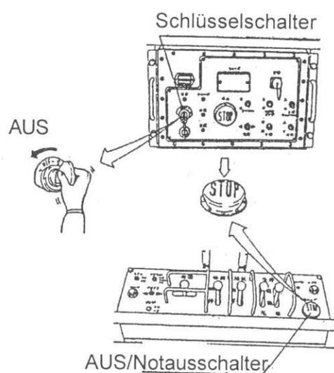
**Achtung :** Sollten Sie die Maschine vom oberen Bedienpult aus, mittels des AUS/Notausschalters gestoppt haben, stellen Sie sicher, dass der Schlüsselschalter an der Bodenkontrolle zusätzlich in die AUS-Position geschaltet wird.
