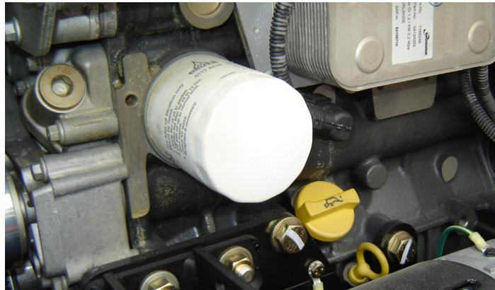
Schmierpunkt(e): Einfüllverschluss/anschaubarer Einsatz
